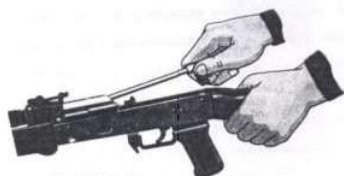
Рис. П.2.21. Отделение возвратного механизма
