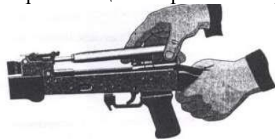
Рис. П.2.22. Отделение затворной рамы с затвором
