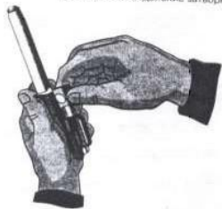
Рис. П.2.22. Отделение затворной рамы с затвором
