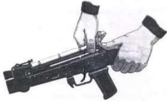
Рис. П.2.20. Отделение крышки ствольной коробки
