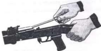
Рис. П.2.21. Отделение возвратного механизма
