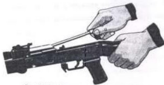
Рис. П.2.21. Отделение возвратного механизма
