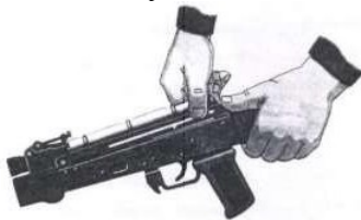
Рис. П.2.20. Отделение крышки ствольной коробки
