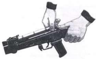
Рис. П.2.20. Отделение крышки ствольной коробки
