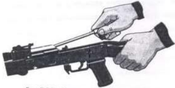
Рис. П.2.21. Отделение возвратного механизма
