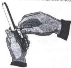
Рис. П.2.22. Отделение затворной рамы с затвором
