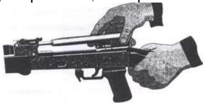
Рис. П.2.22. Отделение затворной рамы с затвором
