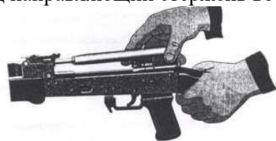
Рис. П.2.22. Отделение затворной рамы с затвором
