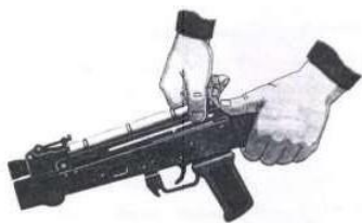
Рис. П.2.20. Отделение крышки ствольной коробки
