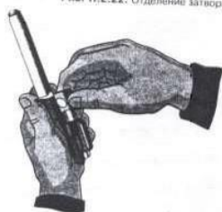
Рис. П.2.22. Отделение затворной рамы с затвором
