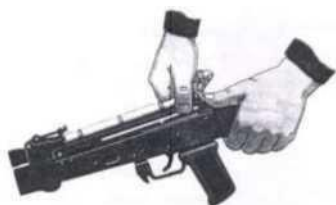
Рис. П.2.20. Отделение крышки ствольной коробки
