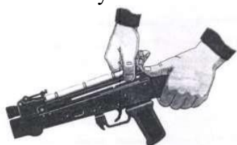
Рис. П.2.20. Отделение крышки ствольной коробки
