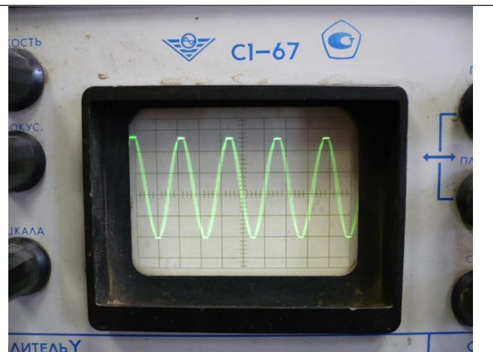
**Задание 3.** По осциллограмме определить вид и параметры сигнала (амплитуду, период, частоту)
