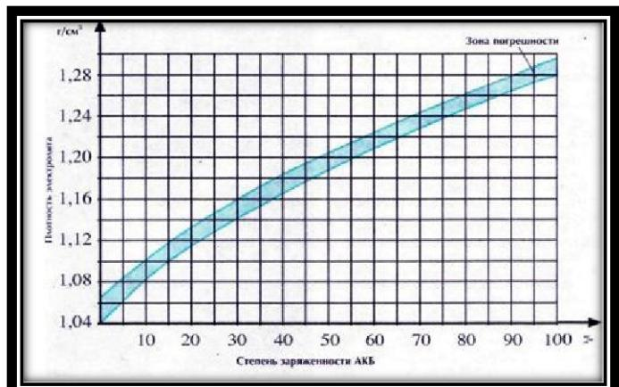
Зависимость плотности электролита от степени заряженности АКБ при  $+25^{\circ}\text{C}$
