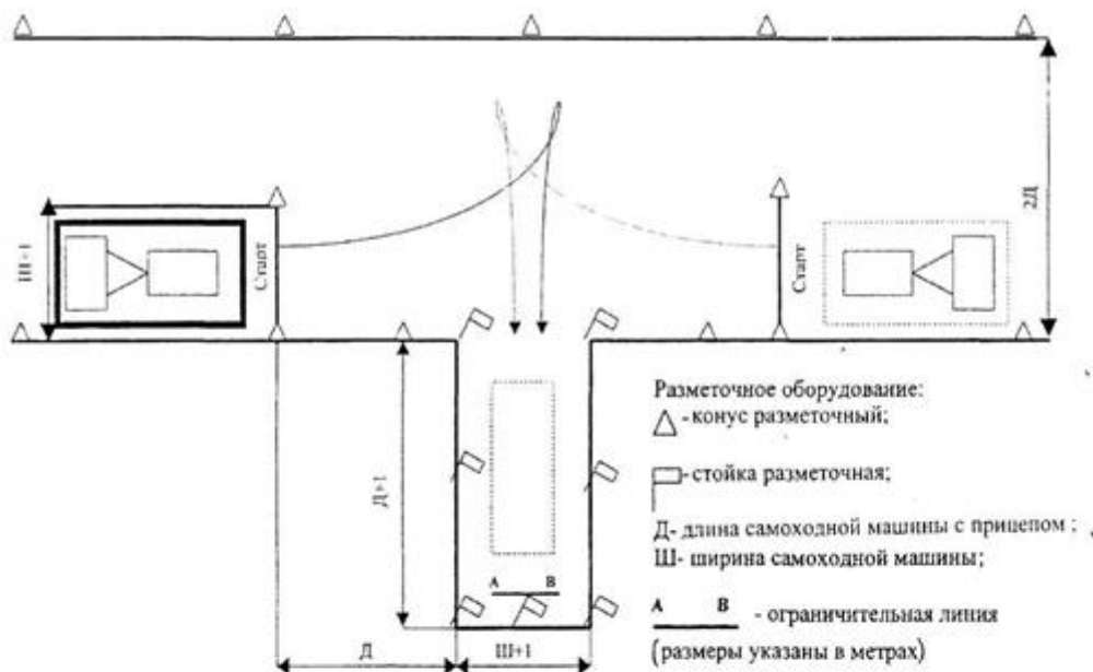
Рис. 8. Постановка самоходной машины в агрегате с прицепом в бокс задним ходом
