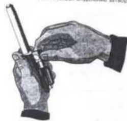
Рис. П.2.22. Отделение затворной рамы с затвором
