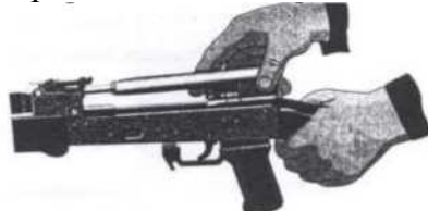
Рис. П.2.22. Отделение затворной рамы с затвором
