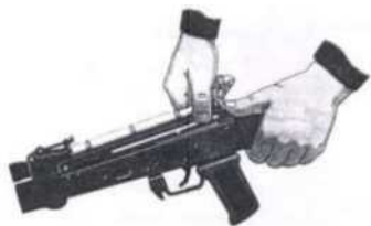
Рис. П.2.20. Отделение крышки ствольной коробки
