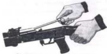
Рис. П.2.21. Отделение возвратного механизма
