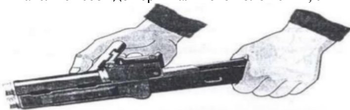
Рис. П.2.24. Отделение газовой трубки со ствольной накладкой
