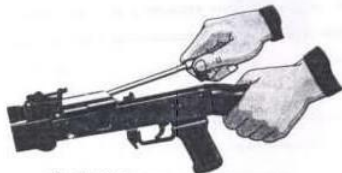
Рис. П.2.21. Отделение возвратного механизма
