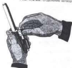
Рис. П.2.22. Отделение затворной рамы с затвором
