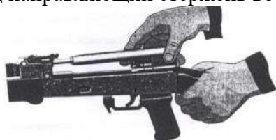
Рис. П.2.22. Отделение затворной рамы с затвором
