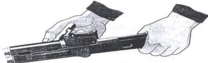
Рис. П.2.24. Отделение газовой трубки со ствольной накладкой
