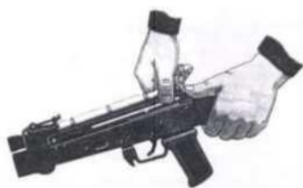
Рис. П.2.20. Отделение крышки ствольной коробки
