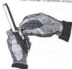
Рис. П.2.22. Отделение затворной рамы с затвором
