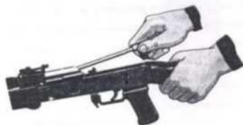
Рис. П.2.21. Отделение возвратного механизма
