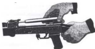
Рис. П.2.22. Отделение затворной рамы с затвором
