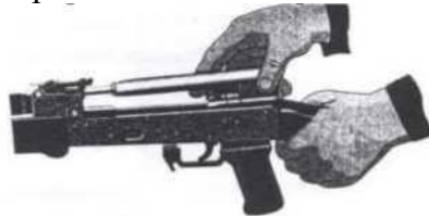
Рис. П.2.22. Отделение затворной рамы с затвором
