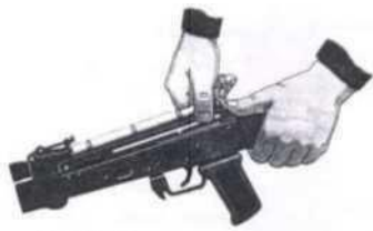
Рис. П.2.20. Отделение крышки ствольной коробки
