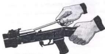
Рис. П.2.21. Отделение возвратного механизма
