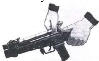
Рис. П.2.20. Отделение крышки ствольной коробки
