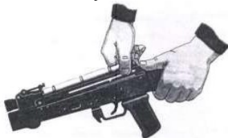
Рис. П.2.20. Отделение крышки ствольной коробки
