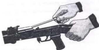
Рис. П.2.21. Отделение возвратного механизма
