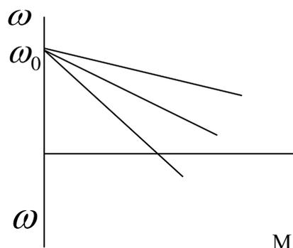
8. Семейство механических характеристик двигателя постоянного тока независимого возбуждения
