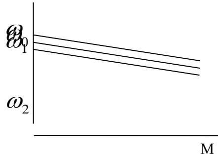
9. При частотном регулировании частоты оборотов вращения асинхронного двигателя необходимо с изменением:
