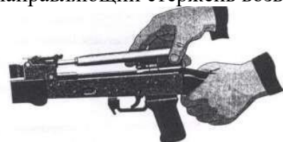
Рис. П.2.22. Отделение затворной рамы с затвором
