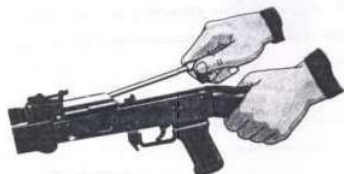
Рис. П.2.21. Отделение возвратного механизма
