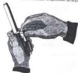
Рис. П.2.22. Отделение затворной рамы с затвором
