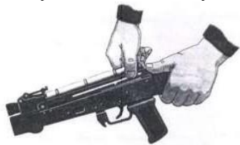
Рис. П.2.20. Отделение крышки ствольной коробки
