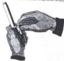
Рис. П.2.22. Отделение затворной рамы с затвором
