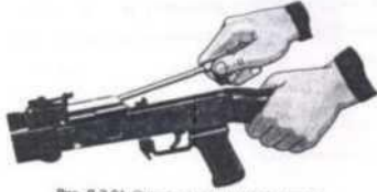
Рис. П.2.21. Отделение возвратного механизма
