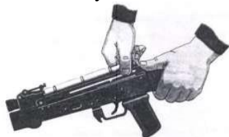
Рис. П.2.20. Отделение крышки ствольной коробки
