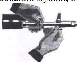
Рис. П.2.18. Отделение шомпола
