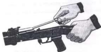
Рис. П.2.21. Отделение возвратного механизма
