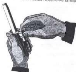
Рис. П.2.22. Отделение затворной рамы с затвором
