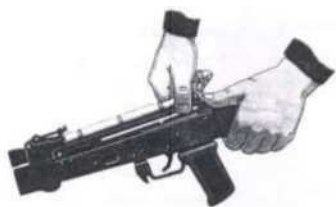
Рис. П.2.20. Отделение крышки ствольной коробки
