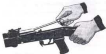
Рис. П.2.21. Отделение возвратного механизма
