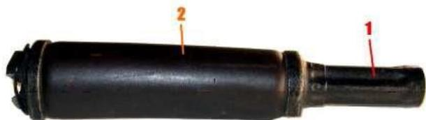
1 - газовая трубка: служит для направления движения газового поршня
