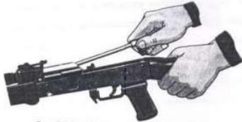
Рис. П.2.21. Отделение возвратного механизма
