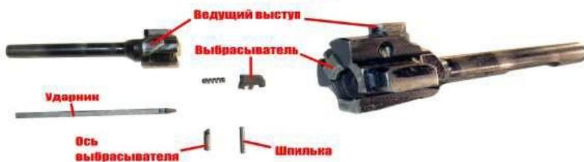
Служит для досылания патрона в патронник, закрывания канала ствола, разбивания капсюля и извлечения из патронника гильзы (патрона).
