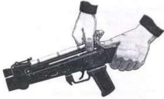
Рис. П.2.20. Отделение крышки ствольной коробки
