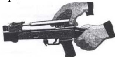
Рис. П.2.22. Отделение затворной рамы с затвором
