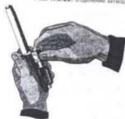
Рис. П.2.22. Отделение затворной рамы с затвором
