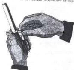
Рис. П.2.22. Отделение затворной рамы с затвором
