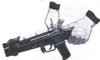
Рис. П.2.20. Отделение крышки ствольной коробки
