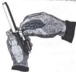
Рис. П.2.22. Отделение затворной рамы с затвором
