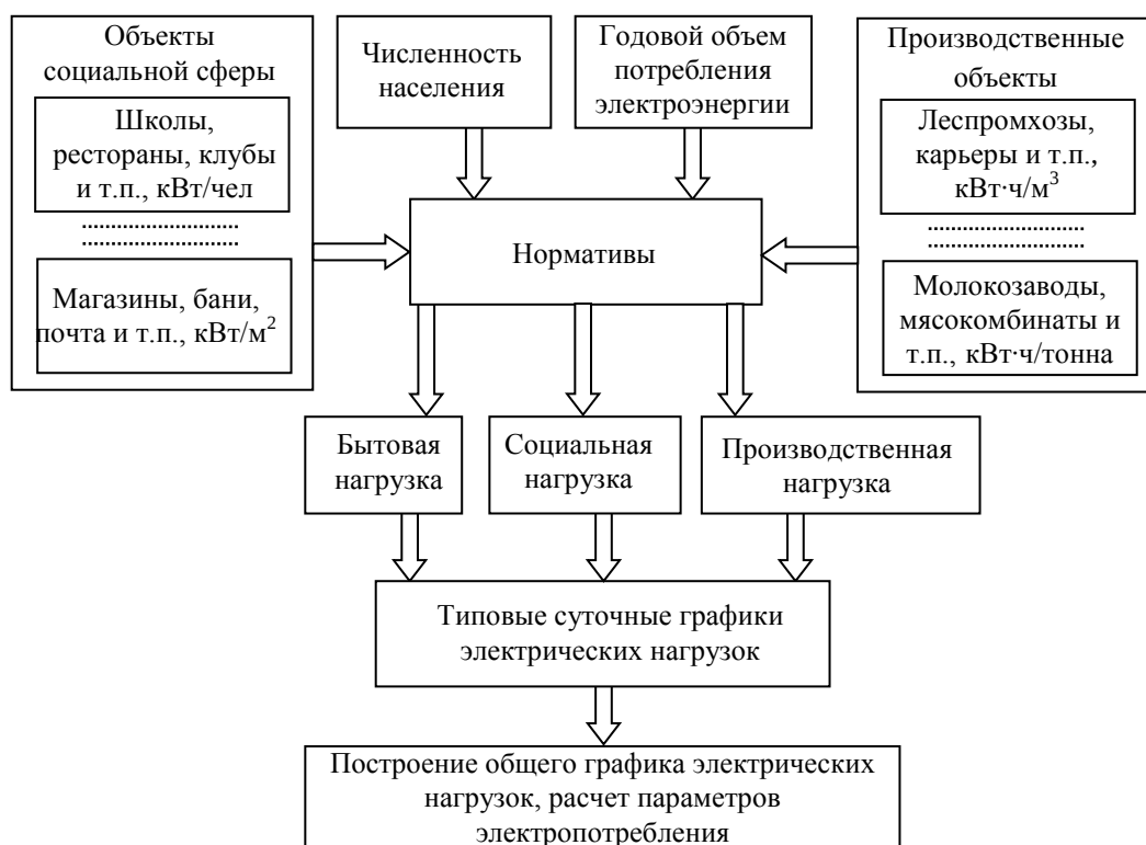
Рис.1. Схема расчета прогнозных режимов потребления электрической энергии автономной системой электроснабжения
