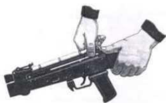
Рис. П.2.20. Отделение крышки ствольной коробки
