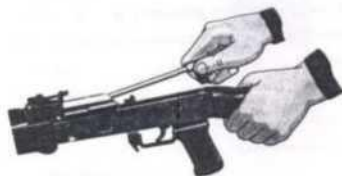
Рис. П.2.21. Отделение возвратного механизма
