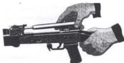
Рис. П.2.22. Отделение затворной рамы с затвором
