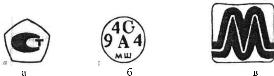
Рис.1. Знаки в метрологии: а - знак утверждения типа СИ; б - поверительное клеймо; в - знак системы добровольной сертификации СИ
