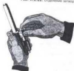
Рис. П.2.22. Отделение затворной рамы с затвором
