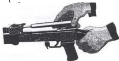
Рис. П.2.22. Отделение затворной рамы с затвором
