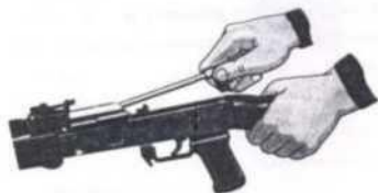
Рис. П.2.21. Отделение возвратного механизма
