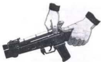
Рис. П.2.20. Отделение крышки ствольной коробки
