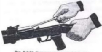
Рис. П.2.21. Отделение возвратного механизма
