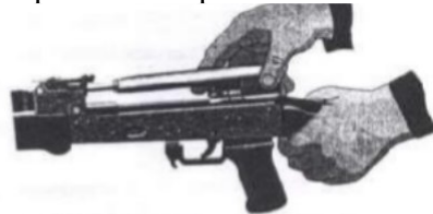
Рис. П.2.22. Отделение затворной рамы с затвором
