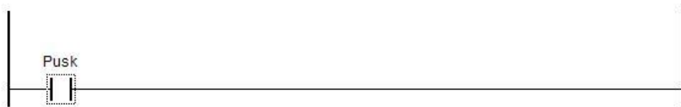
Рис.14 Объявленный замыкающий контакт
