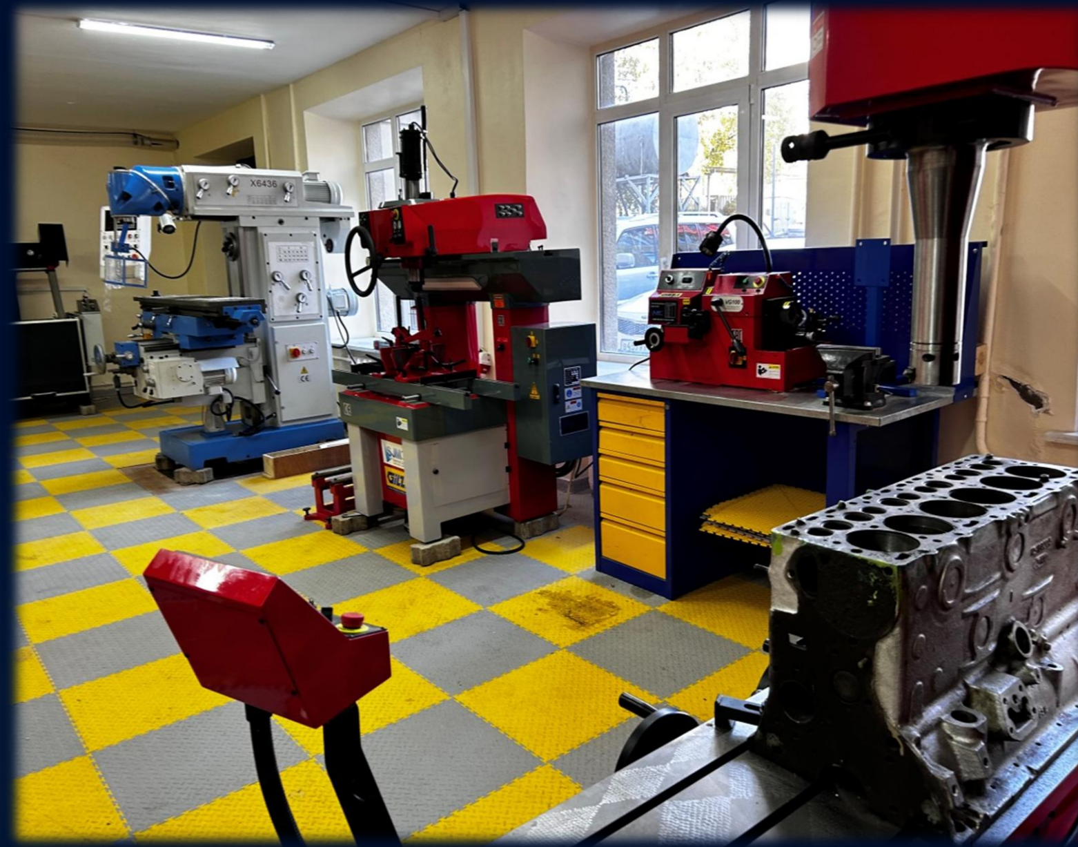
Оборудование лаборатории позволяющее выполнить ремонт и восстановление блоков двигателей и головок блока цилиндров
