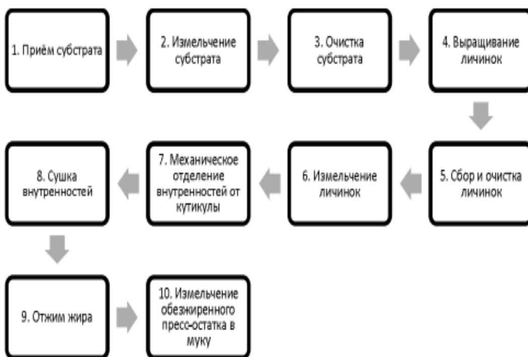
Рисунок 3 – Схема технологии получения протеиновой муки (Д.А. Яковлев, Т.И. Тупольских, Д.В. Рудой, 2019)
