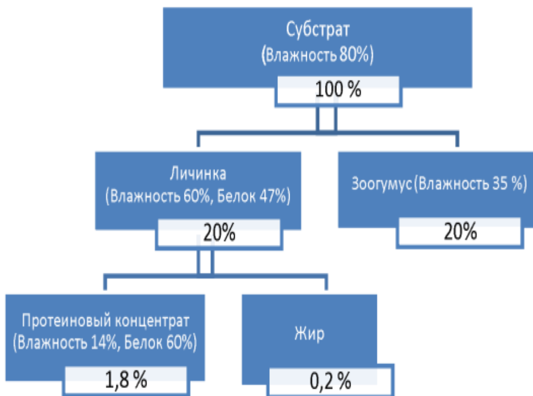
Рисунок 4 – Схема выхода продуктов переработки (Д.А. Яковлев, Т.И. Тупольских, Д.В. Рудой, 2019)
