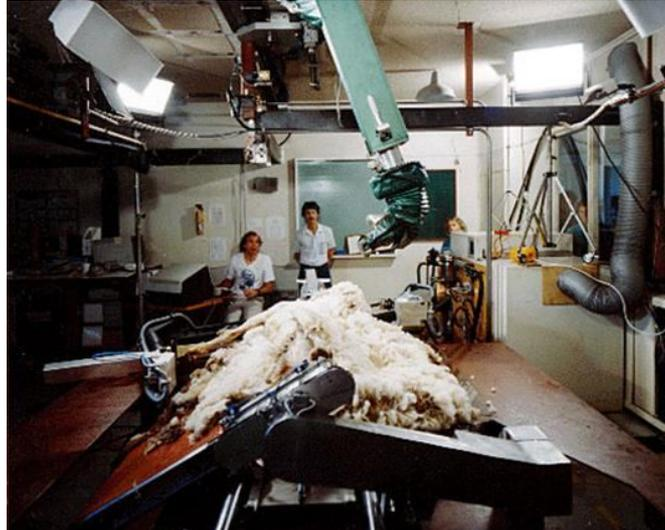
Рисунок 13 – Австралийская автоматизированная станция для стрижки овец The Oracle
