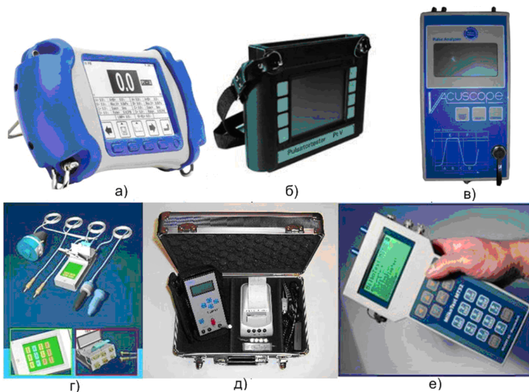
Рисунок 25 - Пневмотестеры ведущих мировых производителей: а) VPR 100 «DeLaval» (Швеция); б) PT V «Exendis» (Голландия); в) Vacuscope «DLG» (Германия); г) Exitest «Eliri S. A.» (Молдавия); д) Digimet 3000 «L. J. Engineering» (США); е) MT 52 «Bilgery AG» (Швейцария)
