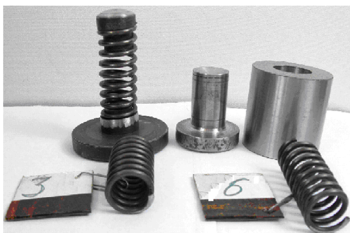
Рисунок 18 – Приспособление для контактного заневоливания пружин: а) детали приспособления; б) приспособление в сборе
