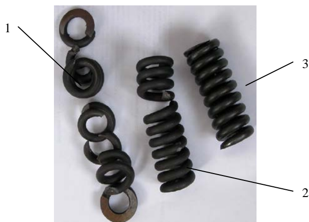
Рисунок 14 – Дефектные пружины гидрозамков подъёмника:
