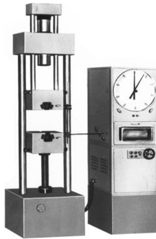
Рисунок 15 – Машина разрывная Р-20
