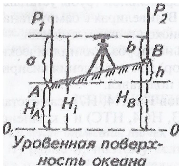
Рисунок 9 – Нивелирование из середины
