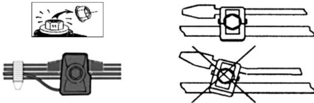
Рисунок 4.- Установка зажима, прокалывающего изоляцию
