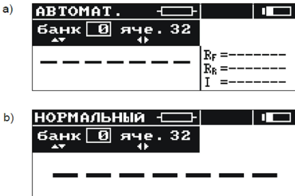
Рисунок 6 - Вид экрана после включения измерителя (объект активного сопротивления, автоматическое введение в память). Способ отображения: а) все результаты; б) только главный результат
