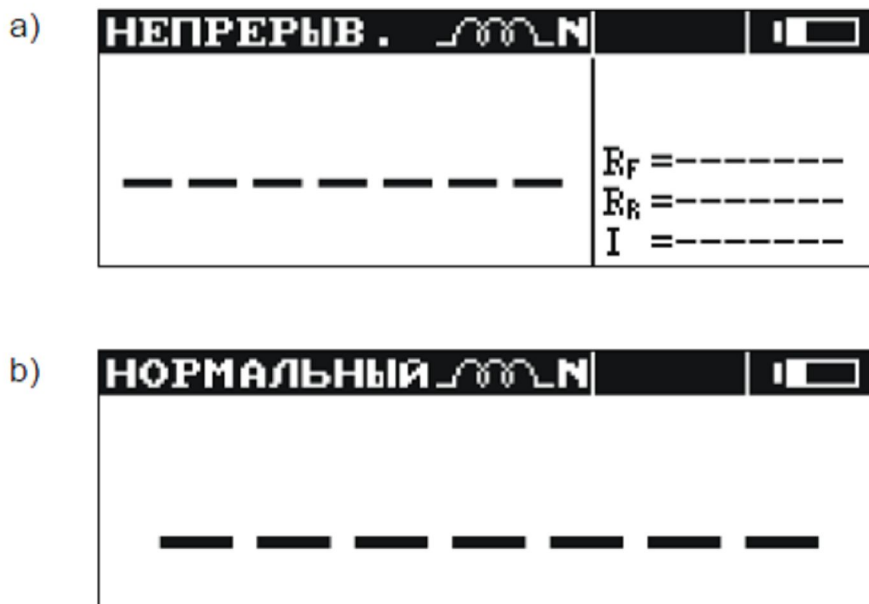
Рисунок 5 - Вид экрана после включения измерителя (тип индуктивного объекта с нормальным временем измерения, ручное введение в память). Способ отображения: а) все результаты; б) только главный результат
