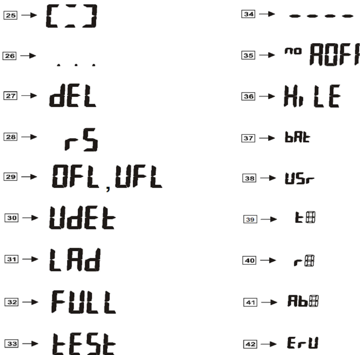
Рисунок 3 – Символы, отображаемые на дисплее прибора MIC-2500
