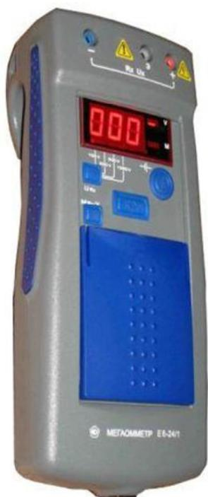
Цифровые мегаомметры Е6-24 и Е6-24/1 предназначены для измерения сопротивления изоляции электрических цепей, не находящихся под напряжением, и измерения переменного напряжения до 400 В. Современный эргономичный корпус, новейшая элементная база.
