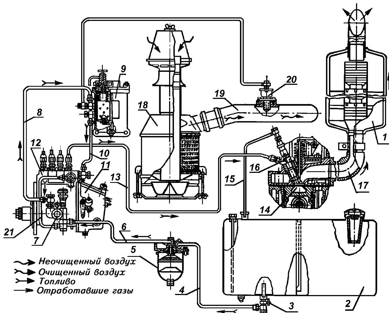
Рисунок 3.1 – Схема системы питания дизелей семейства ММЗ:
