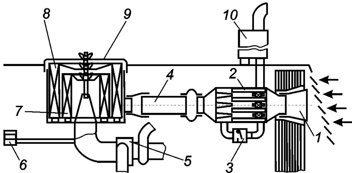
Рисунок 3.6 – Система очистки воздуха тракторного двигателя «Кейс»:
