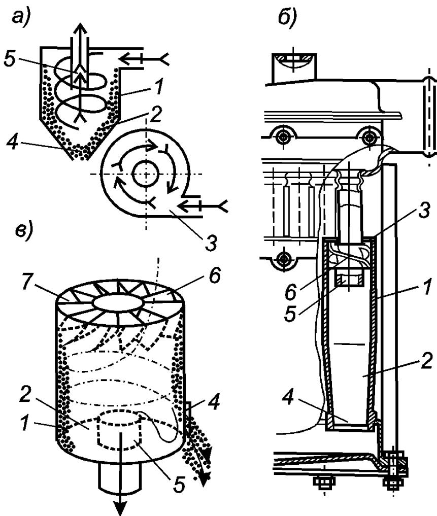
Рисунок 3.2 – Схемы инерционных центробежных устройств воздухоочистителей:
