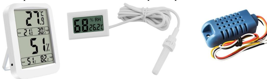
Рисунок 4 – Датчики температуры и влажности совмещенные в одном корпусе: а- стационарный; б – погружной; в – с цифровым модулем
