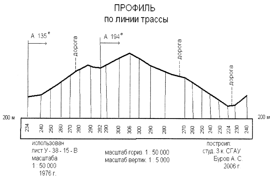
Рис 4 Профиль по линии трассы
